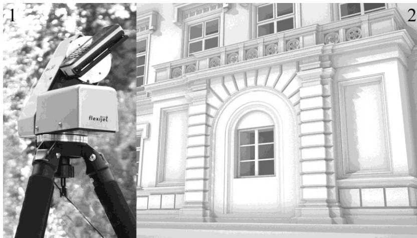
Rys. 1, 2 Urządzenie Flexijet. Model 3D bocznego portalu z elewacji frontowej dawnego Pałacu Królewskiego w Łobzowie, zinventaryzowany systemem Flexijet i opracowany w ArchiCADzie.
